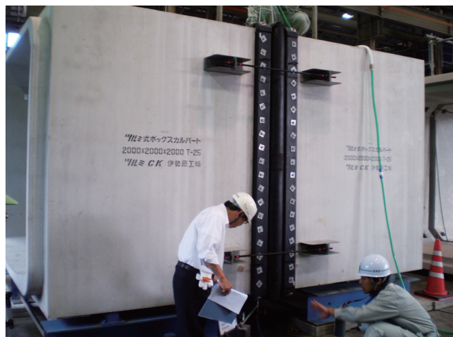
水密試験状況（継手部の確認）
