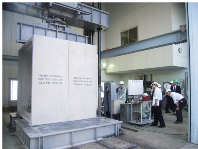
載荷試験状況（本体部の確認）
