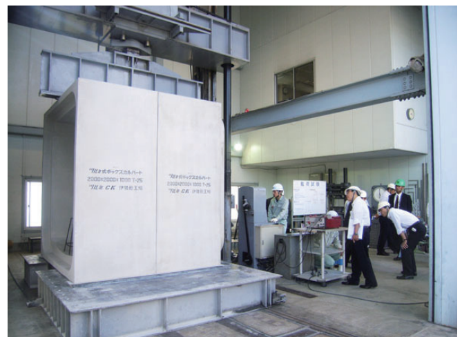
荷重試験状況 (本体部の確認)
