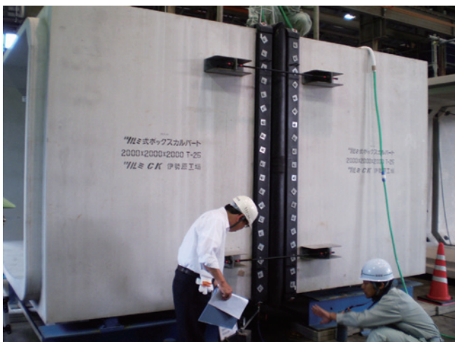
水密試験状況 (継手部の確認)
