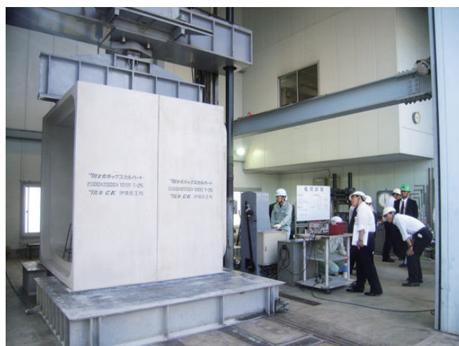
載荷試験状況（本体部の確認）
