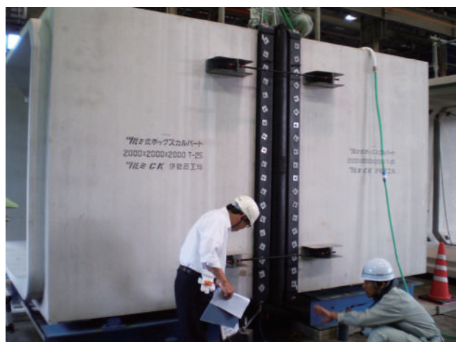
水密試験状況（継手部の確認）
