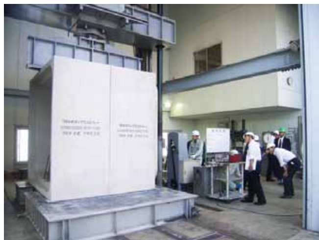
載荷試験状況（本体部の確認）
