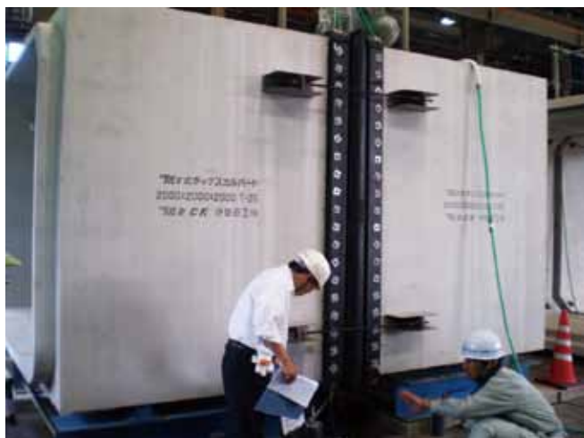
水密試験状況（継手部の確認）
